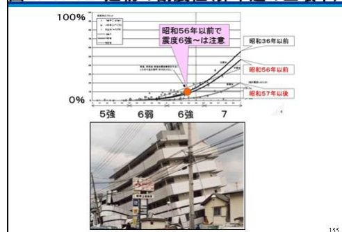
図2. 1. 12 建物の耐震性(非木造の全壊率)
